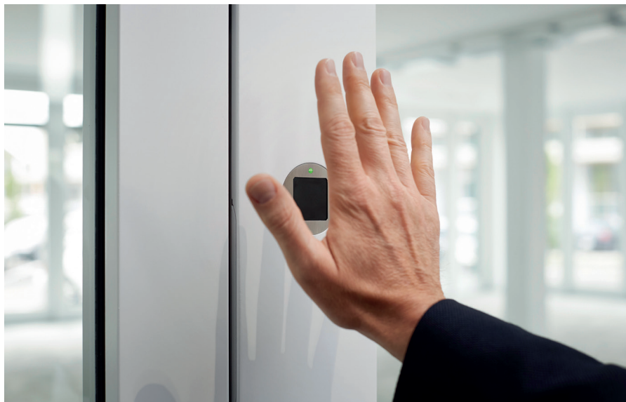
Berührungsfreier handvenenbiometrischer Scanner in Türblatt integriert.
